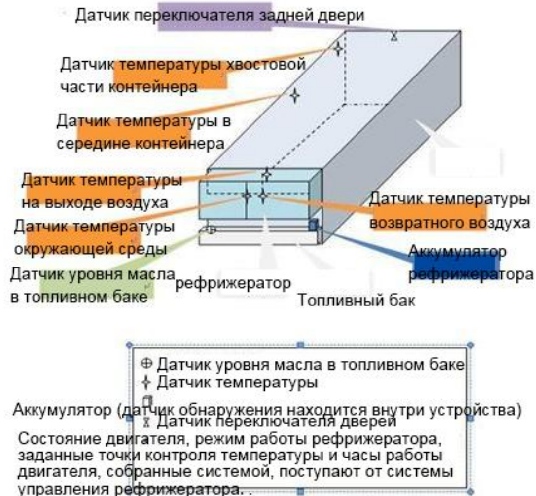
Принципиальная схема датчика рефрижераторных контейнеров
